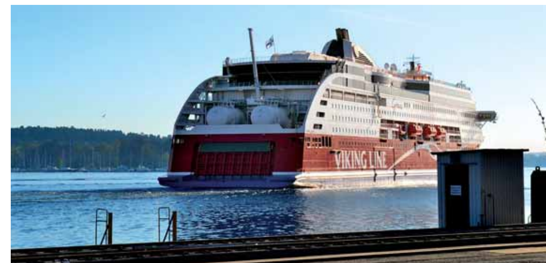
VIKING GRACE Με μήκος 218 μέτρα και πλάτος 31,8 μέτρα, το 57.000 gt cruise ferry της Viking Line μπορεί να μεταφέρει 2.800 επιβάτες με 200 άτομα πλήρωμα. Φέρει 4 κύριες μηχανές Wärtsilä 8L50DF (4 x 7.600 kW) και ταξιδεύει με 22 κόμβους
