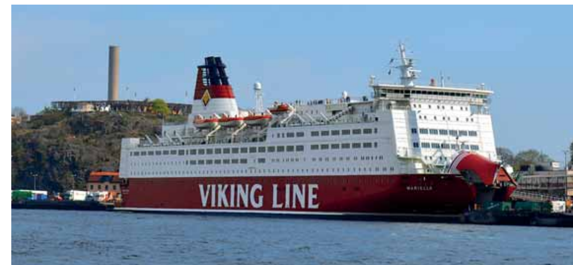
MARIELLA Με μήκος 175,7 μέτρα και πλάτος 28,4 μέτρα, το 37.800 gt cruise ferry της Viking Line μπορεί να μεταφέρει 2.500 επιβάτες. Φέρει 4 κύριες μηχανές Wärtsilä SEMT Pielstick 12 PC (31.000 hp) και αναπτύσσει ταχύτητα 22 κόμβων
